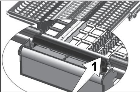
In Modellen mit partieller Bewegungsfunktion können Sie die mittlere Ablage des Korbs durch Drücken des Hebels (1) am Griff auf die unterste Position einstellen. Damit wird das System freigegeben. Dadurch können die rechten und linken Ablagen als bewegliche Teile genutzt werden.
