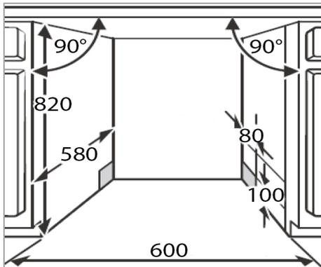
Wenn das Gerät in der Ecke des Unterbaus montiert wird, muss genügend Platz zum Öffnen der Gerätetür verbleiben.
