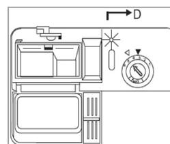
Solange die Warnanzeige nicht aufleuchtet, können Sie die Menge des verbleibenden Klarspülers an der optischen Füllstandsanzeige (D) neben dem Behälter abschätzen.
