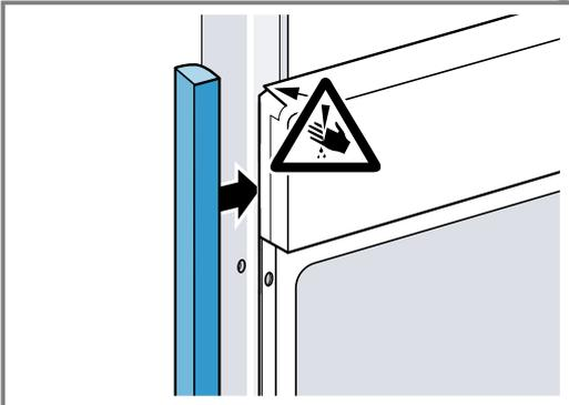
2. Aluprofile vorbohren, um eine Schraubverbindung herzustellen.
