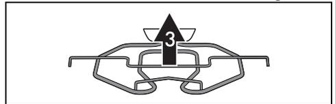
Um den Sockel des Pizzasteins wieder einzusetzen, muss man ihn bis zum Anschlag an die Rückseite des Backofens schieben und so absinken lassen, dass die Platte der Unterhitze in den Sockel einrastet.
