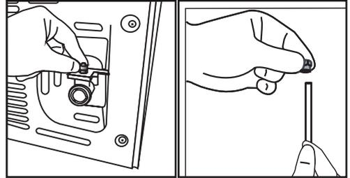
2. Drücken Sie den Wasserschlauch fest nach unten und verbinden Sie ihn mit dem Schlauchtüllenadapter.
