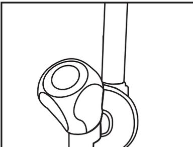
2. Entscheiden Sie, an welcher Stelle Sie den externen Filter anbringen möchten. Befestigen Sie die Filteranschlussvorrichtung (5) an der Wand.
