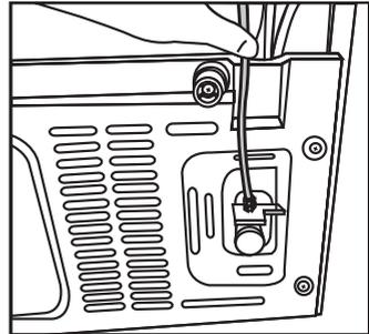
3. Ziehen Sie das Anschlussstück zur Befestigung am Schlauchtüllenadapter von Hand fest. Sie können das Anschlussstück auch mit einer Rohr- oder einer normalen Zange festziehen.
