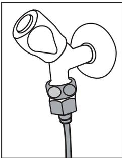
3. Bringen Sie das Anschlussstück um den Wasserschlauch herum an.
