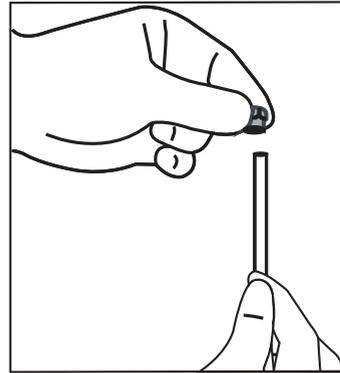
4. Befestigen Sie das Anschlussstück im Wasserhahnadapter und ziehen Sie es von Hand / mit einem Werkzeug fest.
