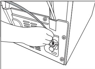
2. Verbinden Sie das andere Ende des Wasserschlauches mit der Wasserpumpe, indem Sie den Schlauch in den Schlauchanschluss der Pumpe drücken.
