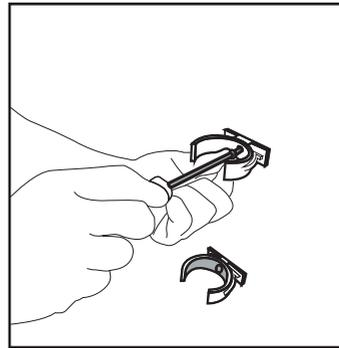
3. Bringen Sie den Filter wie am Etikett gezeigt in aufrechter Position an der Filteranschlussvorrichtung an. (6).
