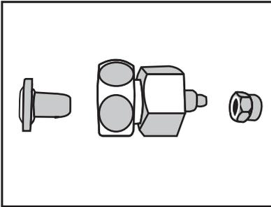
2. Verbinden Sie den Wasserhahnadapter mit dem Wasserleitungsventil.
