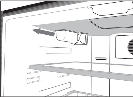
4. Setzen Sie die Wasserfilterabdeckung in den Mechanismus ein, drücken Sie sie zum Einrasten fest.
