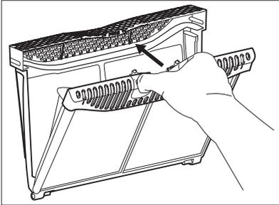
3. Entfernen Sie die Flusen von den beiden inneren Teilen des Filters mit der Hand.
