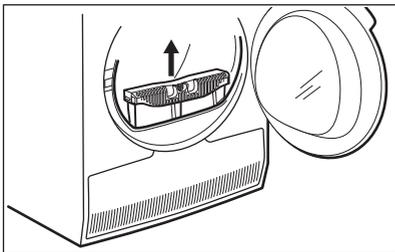
2. Öffnen Sie die Kondensatorabdeckung.
