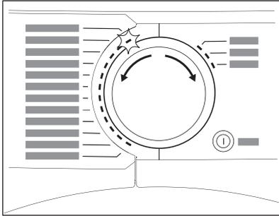
Wählen Sie das gewünschte Programm mit dem Programmwahlschalter aus. Das Display zeigt die ungefähre Programmdauer an.
