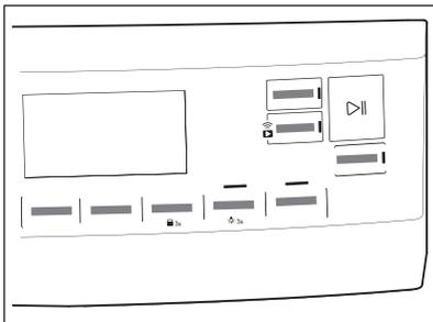
Drücken Sie die entsprechende Taste, um die Option ein- oder auszuschalten. Das Symbol der Option erscheint auf dem Display und die Kontrolllampe über der Taste leuchtet.
