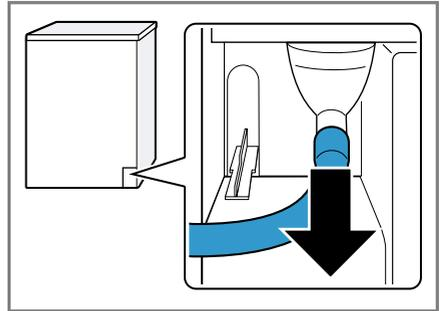
Der Kondenswasserschlauch ist werkseitig am Stutzen angeschlossen.
