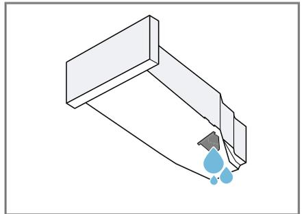
Prüfen Sie regelmäßig den Filter des Kondenswasserbehälters → *Seite 45* und reinigen Sie einen verunreinigten Filter. Stellen Sie sicher, den Kondenswasserbehälter vor dem Betrieb des Geräts einzuschieben. → *"Kondenswasserbehälter einschieben", Seite 37*
